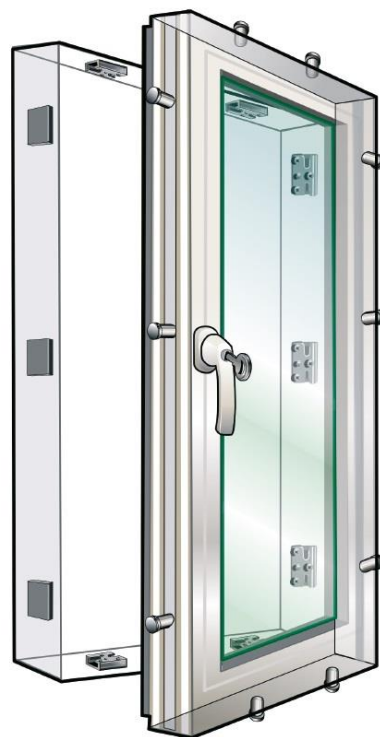
Fenster mit Pilzkopfzapfen, passenden Schließstücken und abschließbarem Fenstergriff
